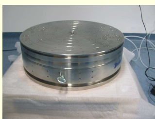
Links: Der Präzisionsdrehtisch mit einer Rundlaufgenauigkeit: < 1 \mu\text{m} .
