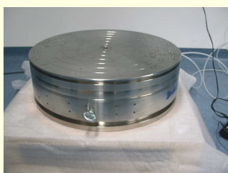
Links: Der Präzisionsdrehtisch mit einer Rundlaufgenauigkeit: < 1 \mu\text{m} .
